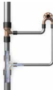
Кольцевая система водоснабжения
